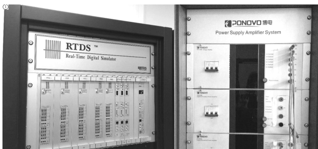
Рис. 2. Элементы ПАК RTDS для сертификационных испытаний
