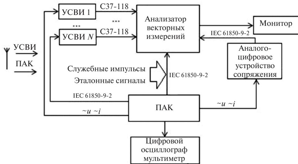
Рис. 1. Тестовая схема для проведения сертификационных испытаний СВИ
