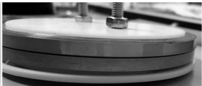
Рис. 8. Полностью сверхпроводящая электрическая машина с осевым магнитным потоком: *a* – общий вид; *б* – ВТСП катушки статора
