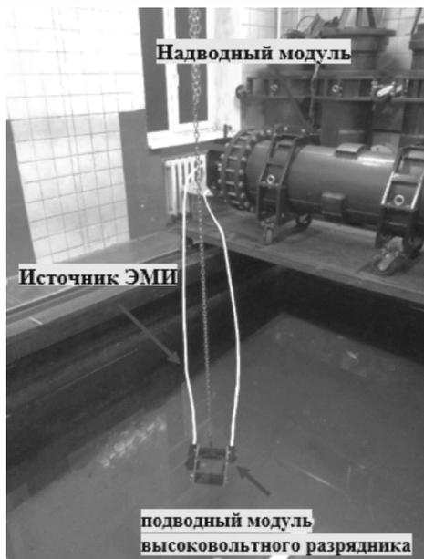
Рис. 4. Система защиты от подводных пловцов «СКАТ» с указанием выявленного источника электромагнитного импульса
