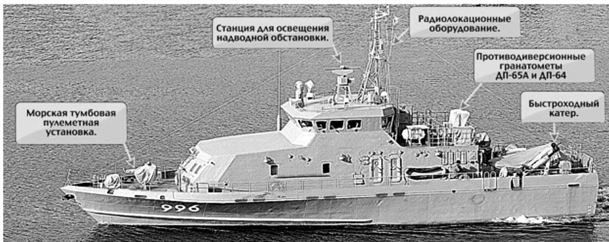
Рис. 15. Противодиверсионный катер «Грачонок» (проект 21980)
