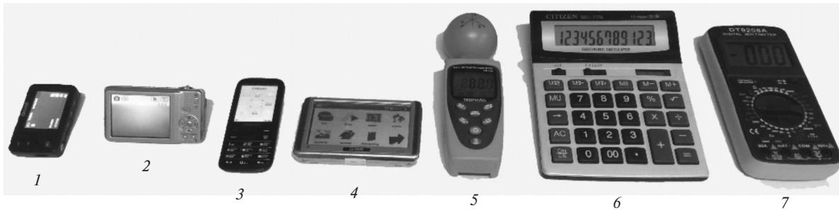
Рис. 13. Цифровая аппаратура, использованная в ходе экспериментов на электромагнитную совместимость: 1 — видеорегистратор Lexand LR-3700; 2 — фотоаппарат LumixDMC-F3; 3 — сотовый телефон PHILIPS XeniumE160; 4 — GPS-навигатор GPS-4358; 5 — индикатор СВЧ-полей Tenmars TM-185; 6 — калькулятор Citizen SDC-270L; 7 — цифровой мультиметр DT9208A
