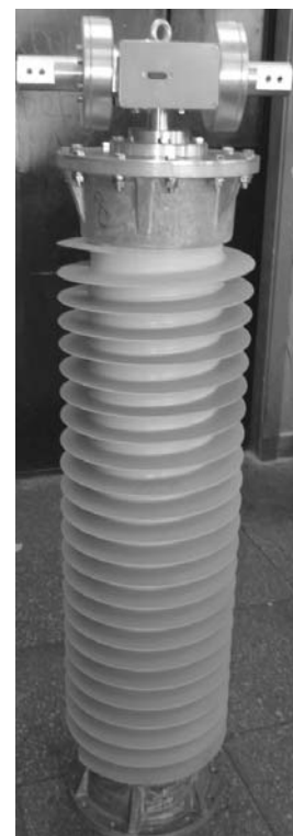
Рис. 4. Цифровой датчик тока и напряжения 110 кВ
