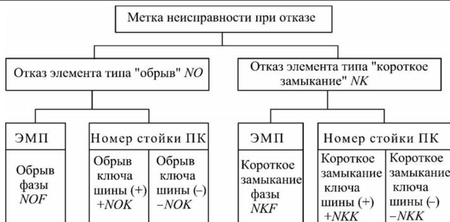
Рис. 1. Метки неисправностей при отказах элементов силовой части
