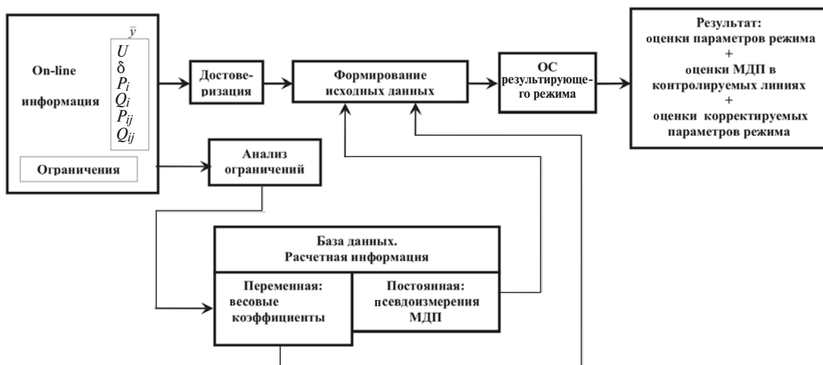
Рис. 2. Схема алгоритма модифицированного метода ОС
