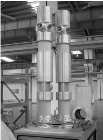
**Рис. 5.** Дугогасительное устройство выключателя для КРУЭ 126 кВ с номинальным током отключения 40 кА
