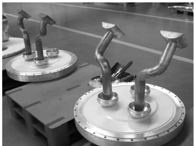
Рис. 12. Герметичный трехфазный изолятор КРУЭ 220 кВ на участке сборки разъединителя-заземлителя (в изоляторе закреплены токоведущие элементы)
