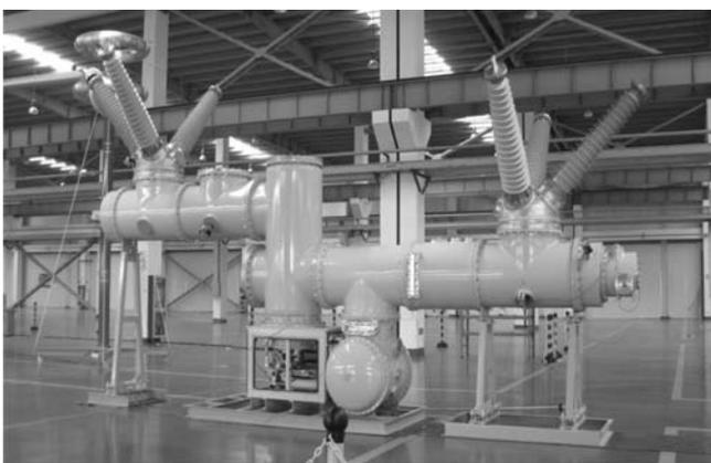
Рис. 3. КРУЭ 126 кВ ВЭИ для LYEC. Испытание электрической прочности изоляции
