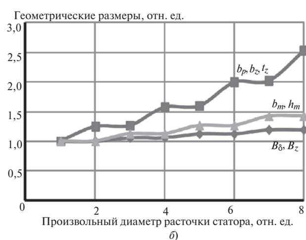
Рис. 4. Закономерности изменения геометрических размеров соразмерного ряда: а – для случая (5); б – для случая (6)
