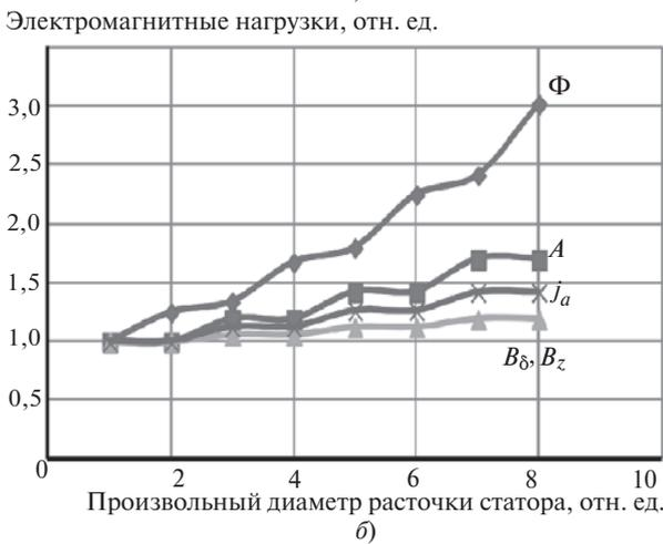
Рис. 2. Закономерности изменения электромагнитных параметров размерного ряда: а – для случая (5); б – для случая (6)
