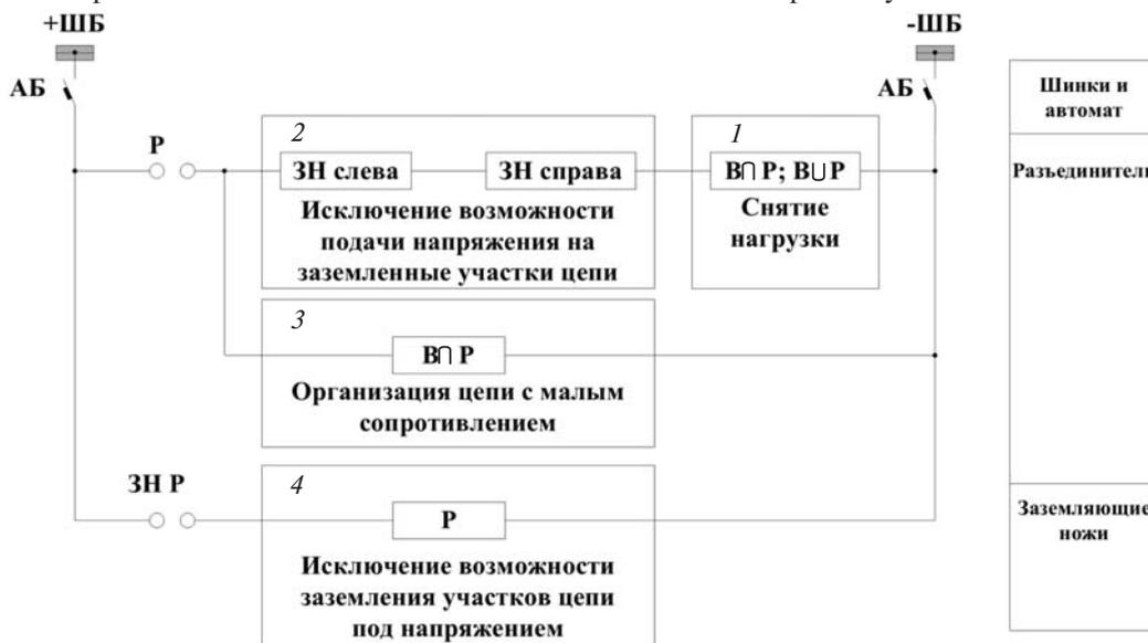
Рис. 3. Схема блока логики: ЗН – заземлитель; Р – разъединитель; В – масляный выключатель
