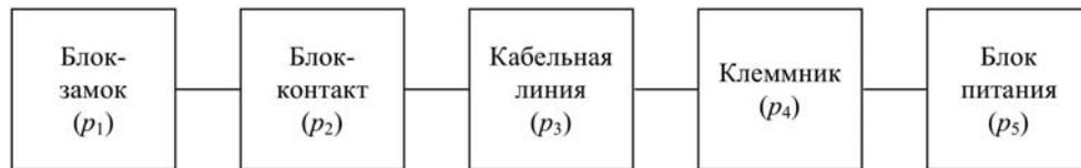
Рис. 5. Структурная схема надежности системы ОББ
