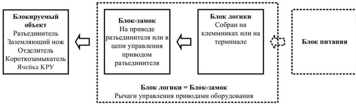
Рис. 1. Структурная схема системы блокировки
