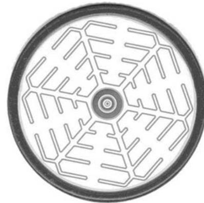
Рис. 4. Топология полупроводникового элемента фототиристора для импульсных применений
