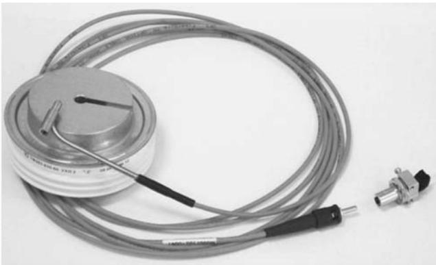
Рис. 1. Конструкция фототиристора
