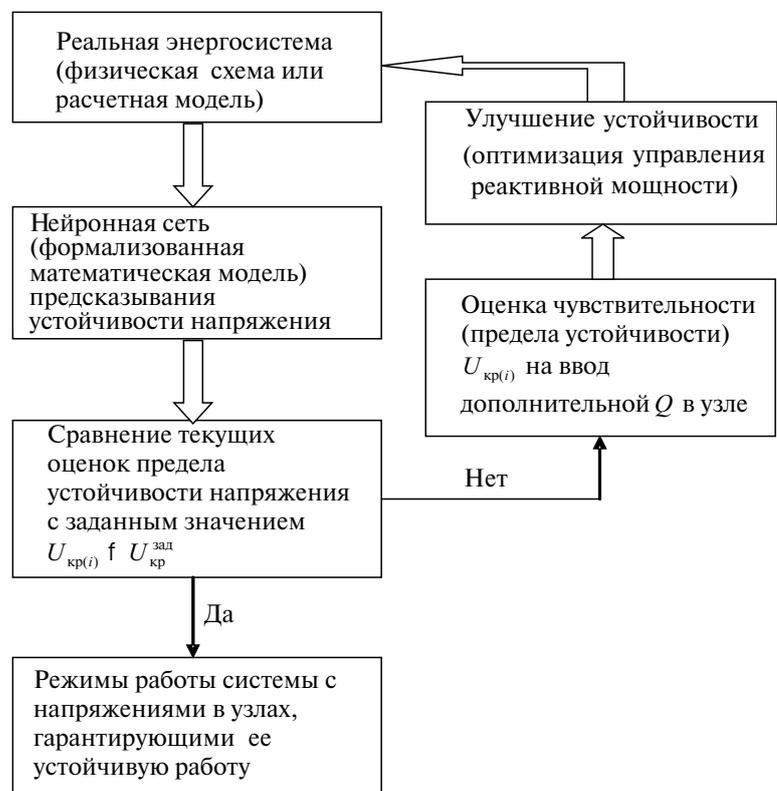
Рис. 2. Принципиальная схема мониторинга текущего значения предела устойчивости по напряжению с помощью модели нейронной сети
