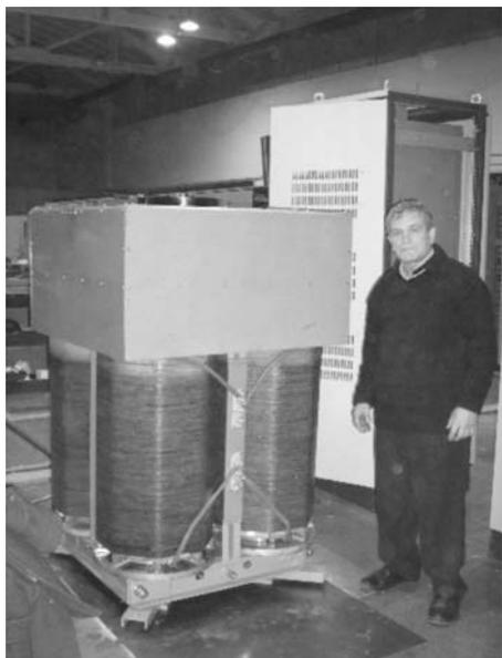
Рис. 6. Общий вид сглаживающего (сухого) дросселя
