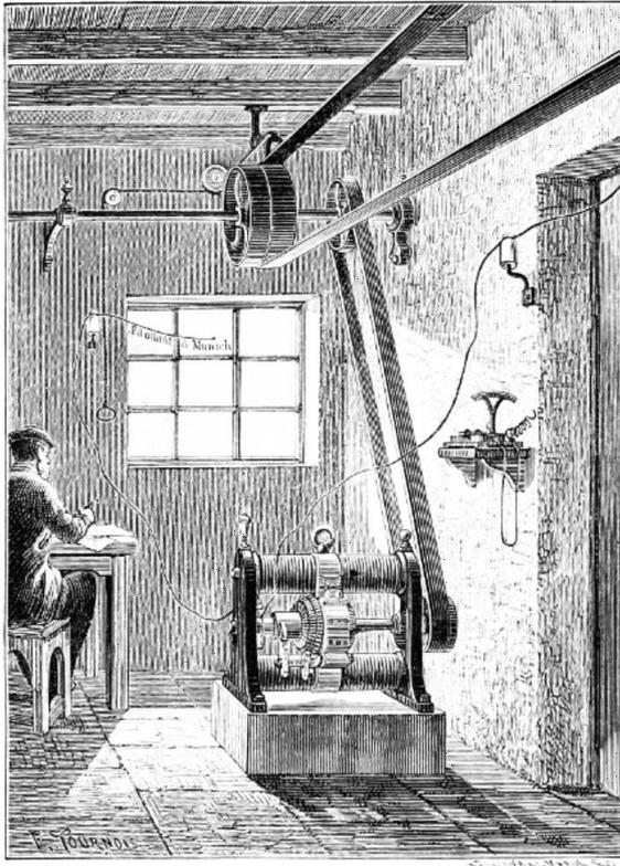
Рис. 9. Генератор конструкции Грамма. Мисбах-Мюнхенская электропередача в 1882 г.
