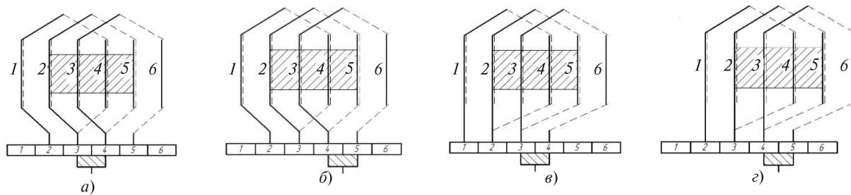
Улучшение коммутации за счет смещения щеток: а — щетки на геометрической нейтрали; б — смещение щеток в направлении вращения на одно коллекторное деление; в — смещение щеток в направлении вращения на одно коллекторное деление за счет переподсоединения секций; г — смещение щеток в направлении вращения на одно коллекторное деление за счет сдвига коллектора относительно центра паза якоря против направления вращения
