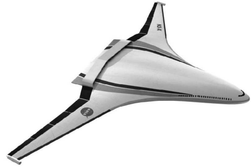
Рис. 21. Улучшение аэродинамического качества при применении распределённой силовой установки
