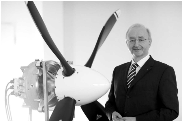
Рис. 23. Силовая установка с электродвигателем Siemens
