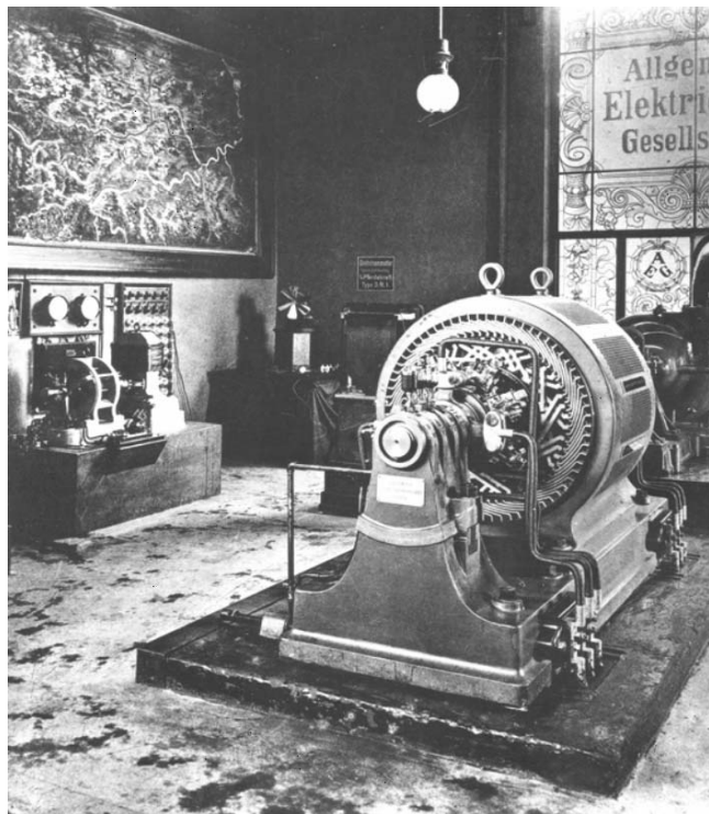
Трехфазный асинхронный двигатель (100 л.с.) М.О. Доливо-Добровольского
