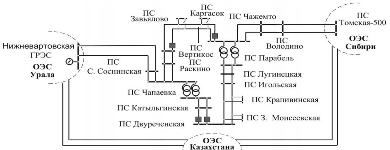
Упрощенная схема сетей 110–220 кВ Томской энергосистемы
