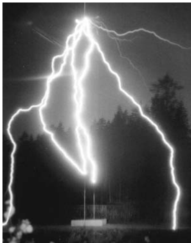
Рис. 4. Серия из пяти разрядов в воздушном промежутке длиной S = 15 м при испытании защиты из двух молниеотводов высотой 3,2 м
