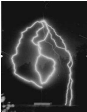
Рис. 9. Серия из пяти разрядов при испытании модели объекта с двумя стержневыми молниеотводами
