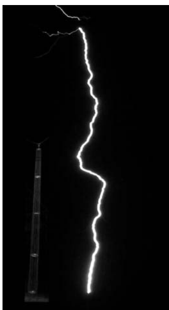
Рис. 2. Разряд в промежутке стержень–плоскость S=20 м при испытании модели опоры высотой 10 м
