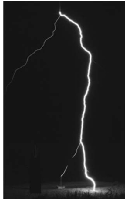
Рис. 7. Разряд в искровом промежутке S = 15 м при испытании модели объекта с одиночным стержневым молниеотводом
