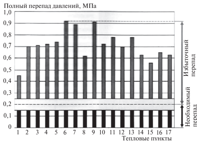
Рис. 1. Потери давления в тепловых пунктах при дросселировании
