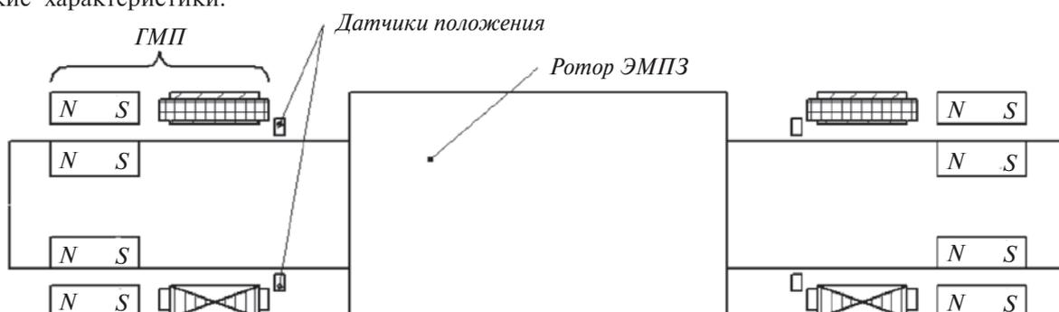
Рис. 1. Магнитный подвес ротора ЭМПЭ на ГМП
