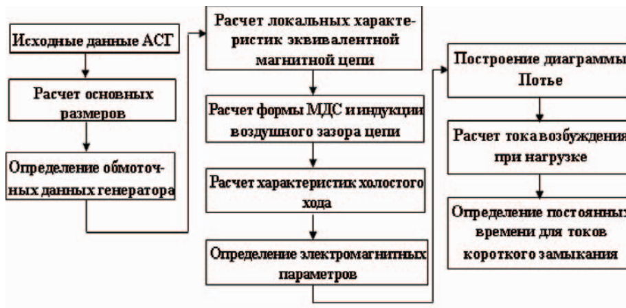
Рис. 3. Порядок выполнения электромагнитного расчета АСГ
