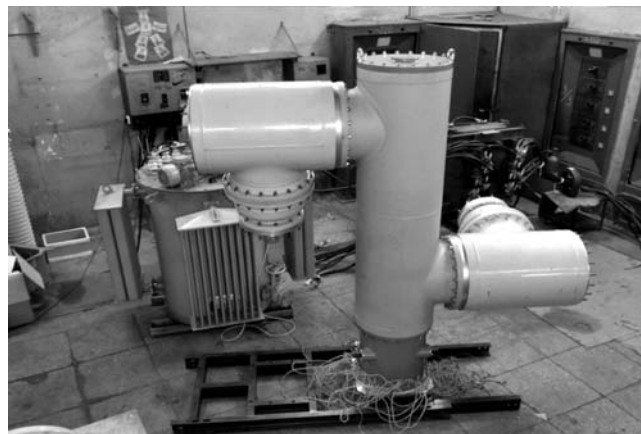
Рис. 3. Выключатель на этапе подготовки к тепловым испытаниям
