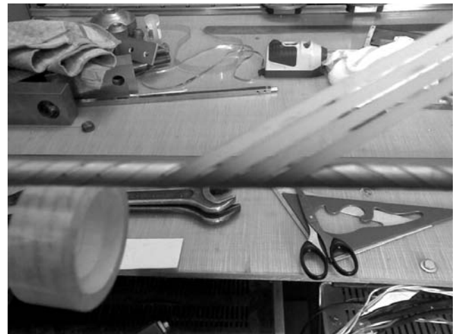
Рис. 3. Намотка 2-го слоя образца токонесящего элемента
