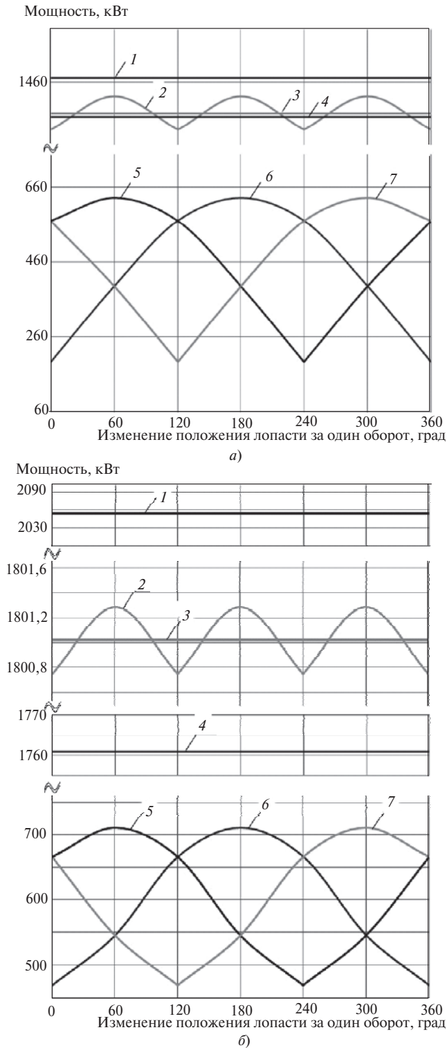
Рис. 7. Мощностная характеристика трех лопастей со смещением на 120^\circ относительно друг друга: а – высота оси вращения ветроколеса 38 м; б – 50 м: 1 – мощность ВЭУ, рассчитанная по формуле (7); 2 – суммарная мощность, рассчитанная для огибающей; 3 – интегральная мощность для графика 2; 5–7 – мощностные характеристики трёх лопастей ветроколеса; 4 – интегральная мощность, рассчитанная для угла установки лопасти j = 0
