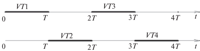
Рис. 2. Диаграмма состояния транзисторов VT1, VT4 при четырёхтактной коммутации: — — транзистор открыт (проводит ток)
