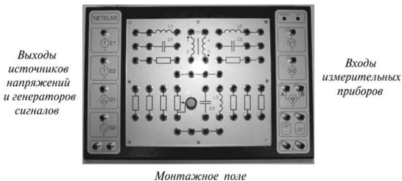
Рис. 3. Измерительный модуль комплекса NETELAB с установленным монтажным полем, обеспечивающим выполнение четырех базовых лабораторных работ по курсу ТОЭ
