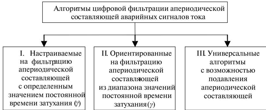
Рис. 1. Основные алгоритмы цифровой фильтрации аperiodической составляющей аварийных сигналов тока
