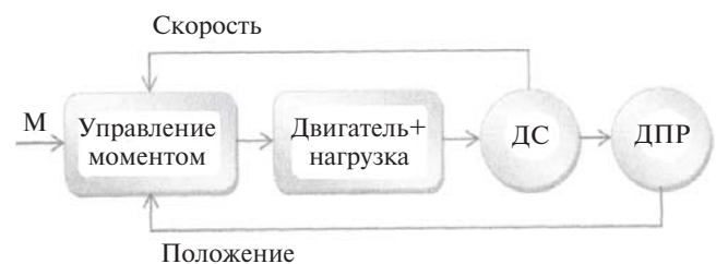
Рис. 4. Структура системы управления тяговым ВИП
