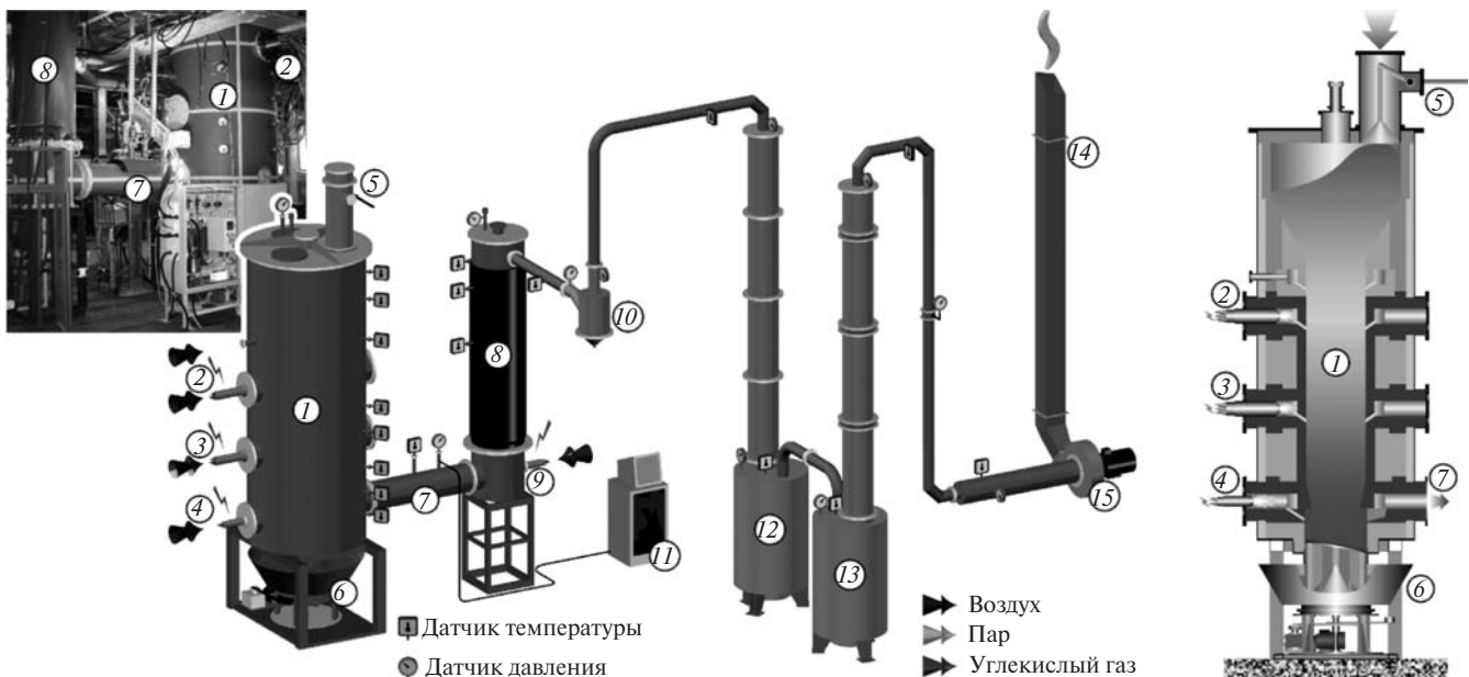
Рис. 1. Технологическая схема и общий вид реакторного узла установки плазменной газификации отходов ИЭЭ РАН: 1 – реактор-газификатор; 2 – основной плазмотрон; 3 – плазмотрон для ввода плазмы в зону восстановления; 4 – плазмотрон для предварительного разогрева зоны вывода шлака; 5 – камера загрузки отходов; 6 – устройство для удаления несгораемых остатков; 7 – газоход отвода сингаза; 8 – дожигатель сингаза; 9 – дежурный факел; 10 – циклон; 11 – газоанализатор; 12 – оросительный скруббер; 13 – насадочный скруббер; 14 – выхлопная труба; 15 – вытяжной вентилятор
