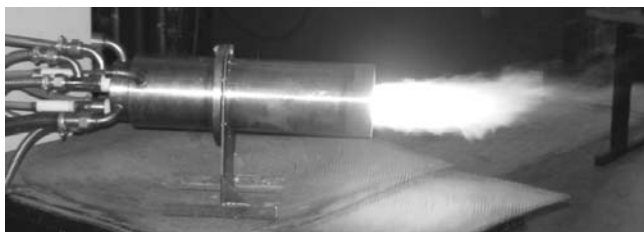
Рис. 2. Генератор воздушной плазмы переменного тока мощностью 40 кВт
