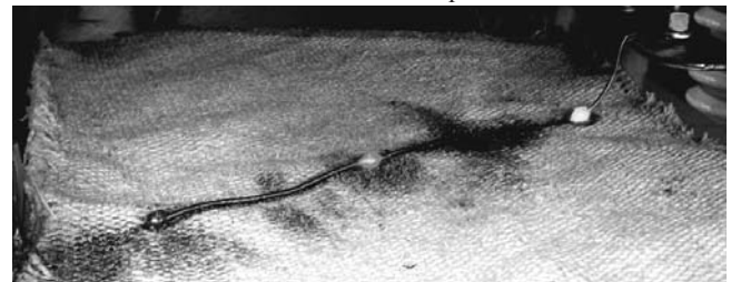
Рис. 8. Опытное распределение вдоль оцинкованного стального провода (параметры см. рис. 4) остывающих на воздухе и теплозащитном асбестовом полотне макроскопических трех «горячих» (высокотемпературных зон ВЭП) и четырех «холодных» (двух крайних при полной сублимации одного из них и двух внутренних) продольных участков после протекания по нему аperiodического импульса тока i_0(t) временной формы 9 мс/576 мс большой плотности ( I_{0m} = 745 А; d_{0m} \gg 0,37 кА/мм 2 )
