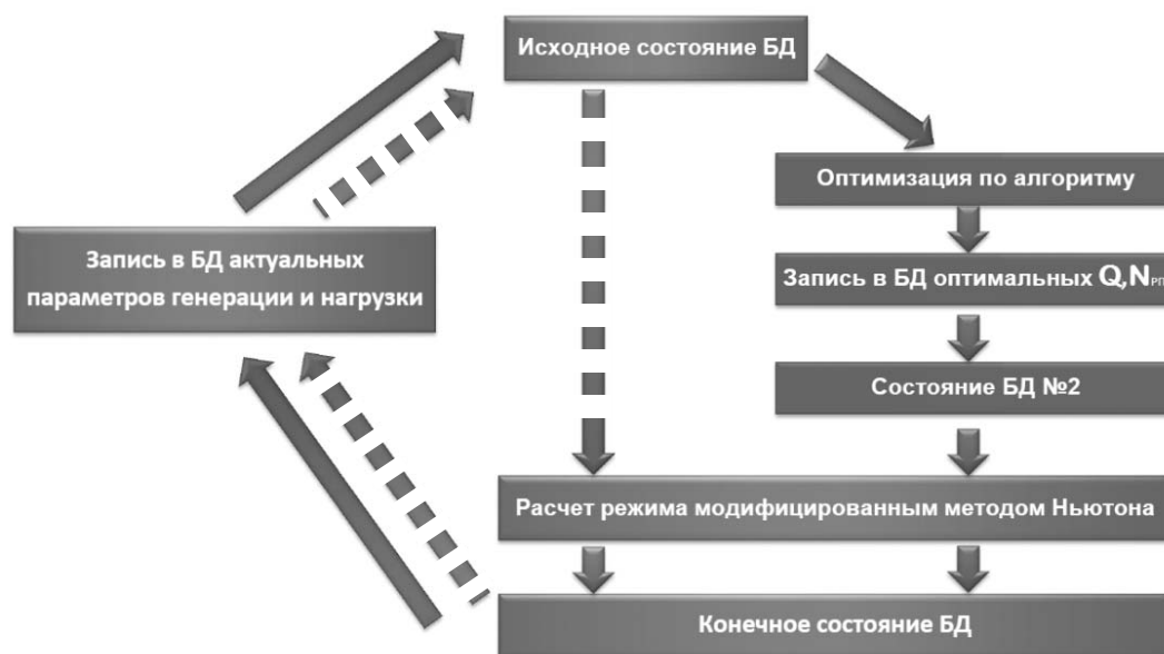
Рис. 2. Принцип расчетов посредством ПО «КАСКАД-НТ» при внедрении алгоритма в качестве подпрограммы (сплошные линии) и при отсутствии такового (---)
