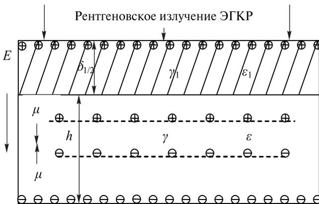
Рис. 4. Схема движения носителей заряда электрета с неравномерным распределением электропроводности по толщине в собственном электрическом поле
