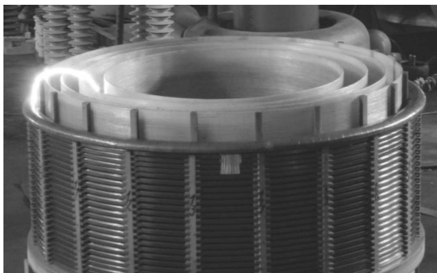
Рис. 1. Вид полного разряда в воздушно-барьерной изоляции макета
