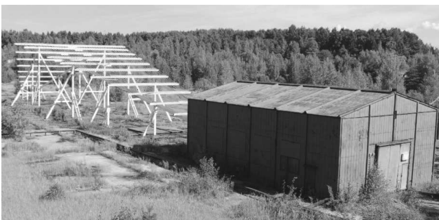
Рис. 4. Стационарный имитатор ЭМИ ЯВ «Аллюр»; габариты имитатора: 100×35×13,5 м; рабочий объем: 10×10×10 м; форма импульса 2,5/25 нс; максимальная напряженность импульса электрического поля 70 кВ/м
