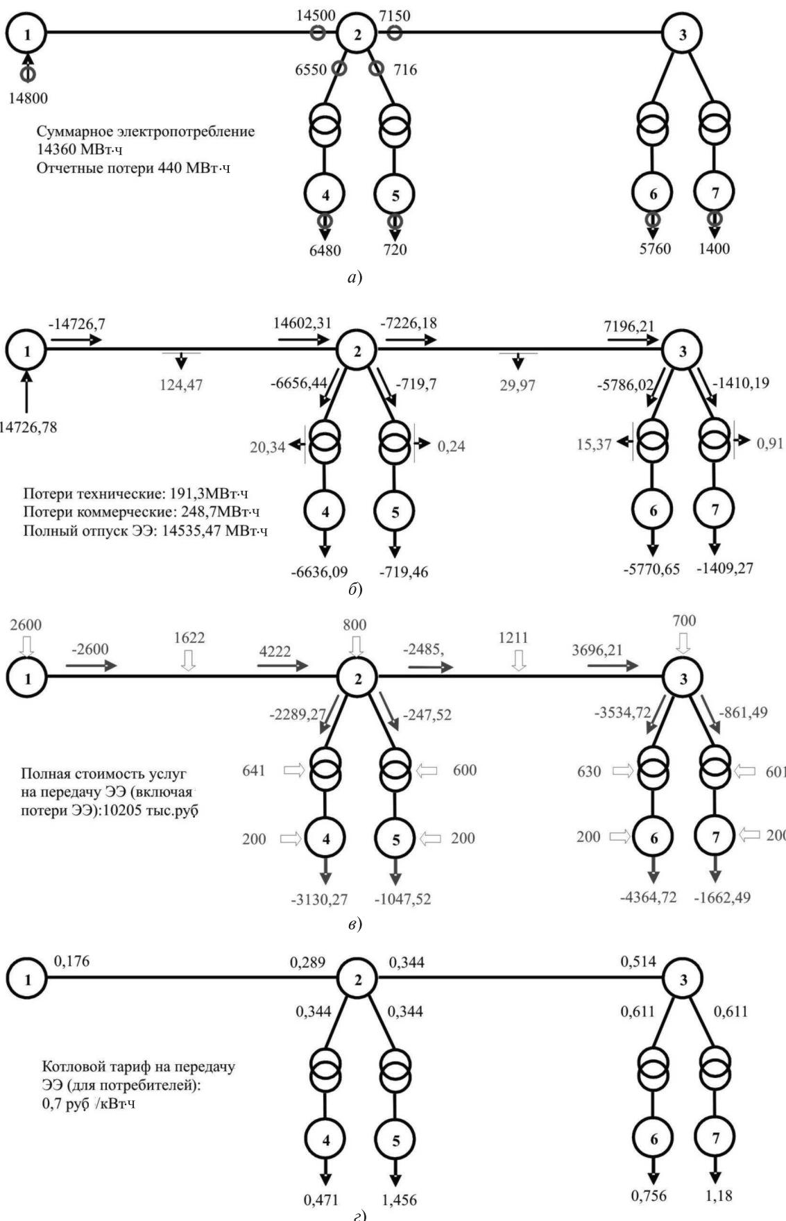
Распределение измерений на схеме электрической сети: а – электроэнергии (○), МВтч; б – расчетных потоков ( $\rightarrow$ ) и потерь ( $\downarrow$ ) электроэнергии (МВтч); в – элементной ( $\Downarrow$ ) и потоковой стоимости ( $\rightarrow$ ), тыс. руб.; г – точечных тарифов на передачу электроэнергии руб./кВтч
